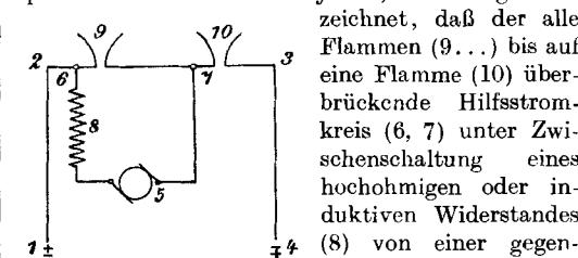
daß der alle Flammen (9...) bis auf eine Flamme (10) überbrückende Hilfsstromkreis (6, 7) unter Zwischenschaltung eines hochohmigen oder induktiven Widerstandes (8) von einer gegenüber der Elektrizitätsquelle des Arbeitsstromkreises (1, 2, 3, 4) unabhängigen Elektrizitätsquelle von genügend hoher Spannung gespeist wird. —
