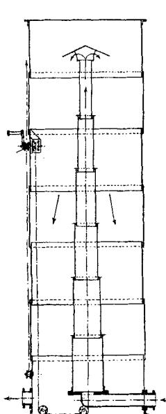
**Patentanspruch:** Luftkühler für Gase, dadurch gekennzeichnet, daß er in seinem Innern mit ein- und ausziehbaren Röhren ausgerüstet wird, durch welche das Gas ein- und austritt, und die je nach der gewünschten Kühlwirkung verlängert oder verkürzt werden können. —
