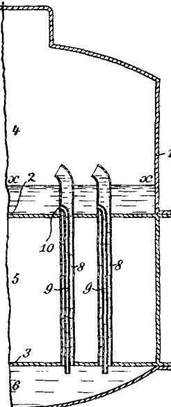
tischen Laboratorien und den Fabriken von Essenzen und Parfümerien. Er hat seinen Platz über der Retorte zwischen Helm und Hals und besteht aus einem System von sechseckigen, nahtlosen Röhren. Hauptvorzüge sind Ersparnis von 50% Heizmaterial und Arbeit, sowie Schnelligkeit der Operation. Mit dem Apparate kann man Alkohol jeder Grädigkeit im voraus bestimmt erhalten.
